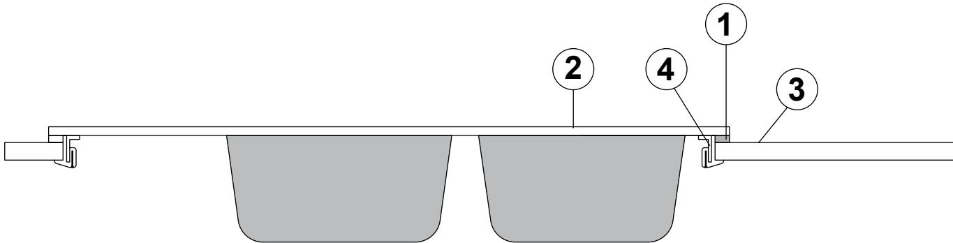
**- 1 IT** - GUARNIZIONE **EN** - SEAL **FR** - GARNITURE **DE** - DICHTUNG **ES** - JUNTA DE ESTANQUIEDAD **RU** - ПРОКЛАДКА **PRC** - 密封条
