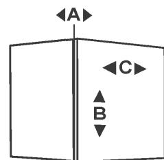
Desserrer/serrer pour ajuster la porte horizontalement
