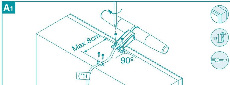
Sistema de enganche a madeira / Sistema de fixação à madeira / Système d'accrochage sur panneau miroir / Attachment to wood / Verankerungssystem für Holzrahmen / System mocujący do drewna
