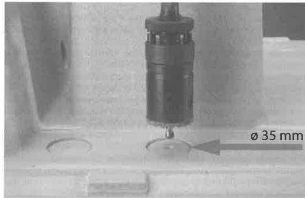
**IT - FORO PER IL RUBINETTO.** Il lavello è predisposto per l'installazione del rubinetto su entrambi i lati con un preforo non passante Ø35 mm. Ciò consente la scelta del verso del posizionamento al momento dell'installazione da parte dell'utente. Il completamento del foro, nel verso desiderato, può essere adeguatamente effettuato agendo dal lato non a vista del lavello, utilizzando una fresa a tazza Ø35mm. (reperibile presso qualsiasi ferramenta) montata su un normalissimo trapano manuale.
